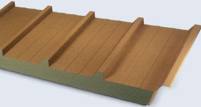
Pannelli per copertura sono composti da **2 strati in acciaio**, con interposto in modo solidale un **isolamento in lana di roccia** da 100 kg/m<sup>3</sup>, a fibre orientate e giunti sfalsati ad alta densità.
